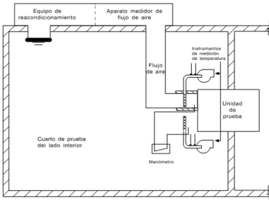
FIGURA 5. Aparato de medición de flujo de aire
